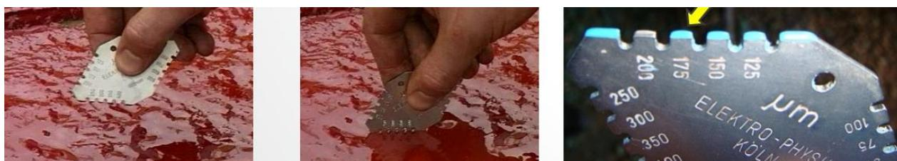
Medidor de espessura úmida (pente de aço inox)
