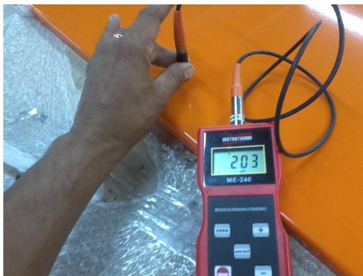
Medidor de espessura eletrônico
