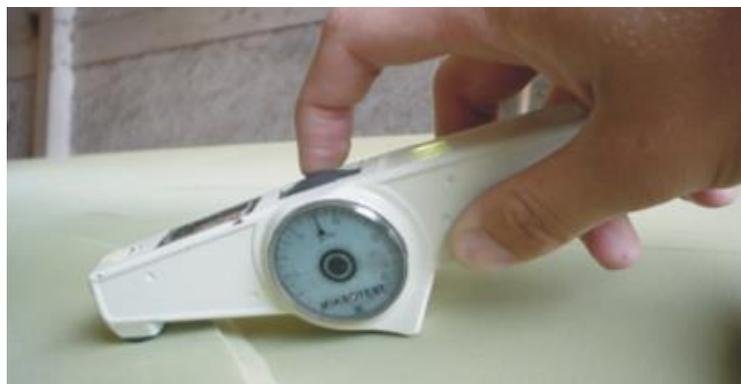
Medidor de espessura seca magnético
