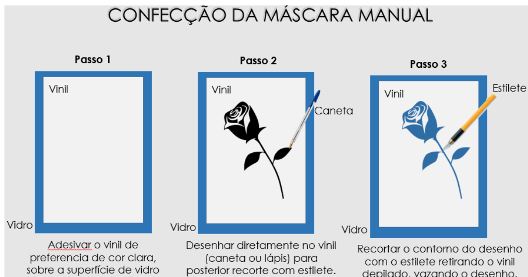
Passos para confecção de máscara (molde vazado) manual
