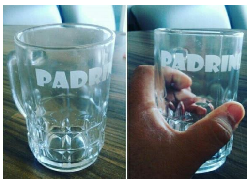
Exemplo de Jateamento com uso de máscara (molde vazado)
