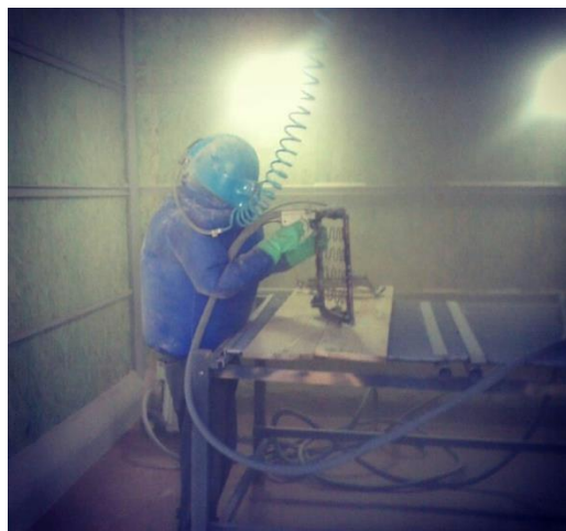
Interior de uma cabine de jateamento 3x3m
