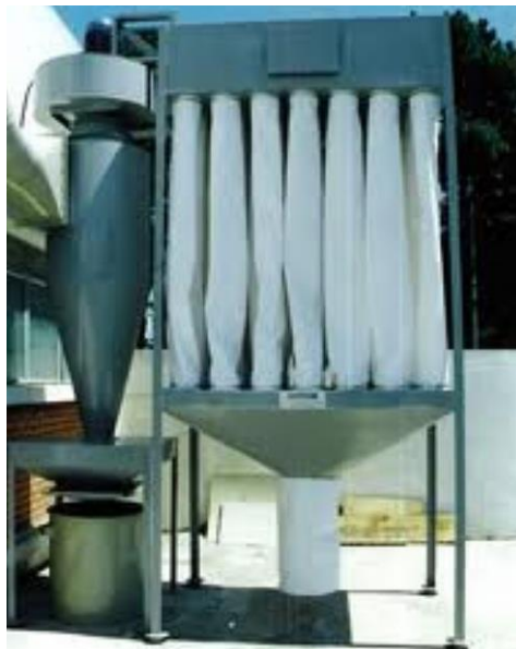
Sistema de exaustão de filtro de mangas e ciclone
