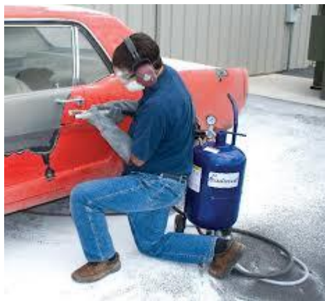
Jateamento com bicarbonato de sódio
