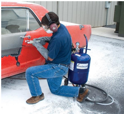
Operador jateando um carro com bicarbonato de sódio ( www.eastwood.com ) restauração de veículos
